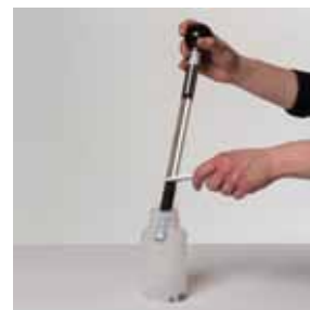
1c) Medida del volumen de prueba con el muestreador graduado (p. ej. terrenos minerales)
