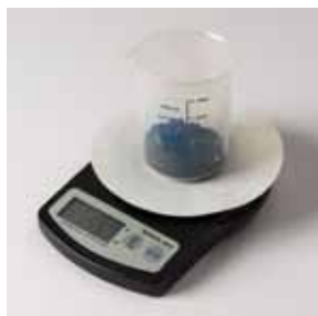
y) Pesada de la prueba del suelo para indicar el contenido de nutrientes en mg/kg
