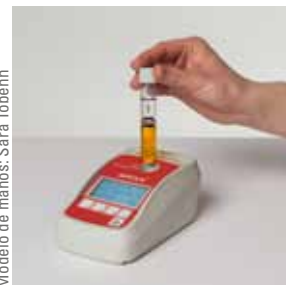
9) Insertar la cubeta de medición en el aparato AMOLA® y leer directamente el valor de medición en p. ej. kg/ha (terrenos minerales) o mg/l Sustrato (sustrato) o ...
