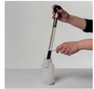
1c) Medida del volumen de prueba con el medidor graduado (p. ej. terrenos minerales)
