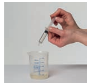
5) Medida del filtrado con jeringa de plástico graduada
