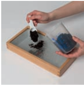
1a) Homogeneización de la prueba del suelo mediante la criba
