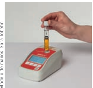
9) Insertar la cubeta de medición en el aparato AMOLA® y leer directamente el valor de medición en p. ej. kg/ha (terrenos minerales) o mg/l Sustrato (sustrato) o ...
