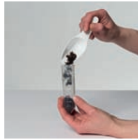
1b) Medida del volumen de prueba con el vaso de muestras graduado (p. ej. sustrato de cultivo de jardinería)
