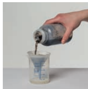
4) Filtrado del extracto con un filtro
