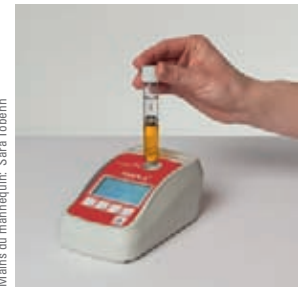
9) Enfichage de la cuvette de mesure dans l'appareil AMOLA® et lecture directe de la valeur de mesure par ex. en kg/ha (sols minéraux) ou mg/l substrat (substrat) ou ...
