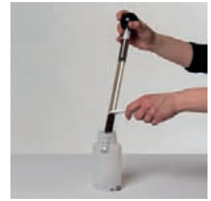
1c) mesure du volume d'échantillon à l'aide de l'échantillonneur gradué (p.ex. sols minéraux)
