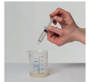
5) Mesure du filtrat par seringue plastique graduée
