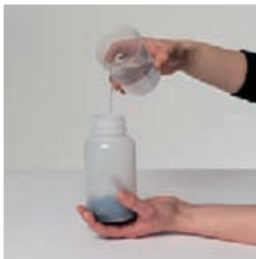
2) Mélange des échantillons avec du produit d'extraction
