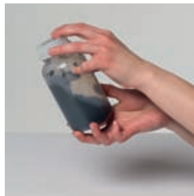
3) Estrazione tramite scuotimento ripetuto
