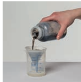
4) Filtrazione dell'estratto con un filtro tondo
