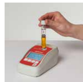
9) Einstecken der Messküvette in das AMOLA® Gerät und direktes Ablesen des Messwertes in z.B. kg/ha (Mineralböden) oder mg/l Substrat (Substrat) oder ...
