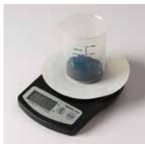
und) Einwaage der Bodenprobe zur Angabe des Nährstoffgehaltes in mg/kg
