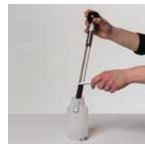
1c) Abmessen des Probevolumens mit dem graduierten Probennehmer (z.B. Mineralböden)
