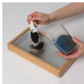
1a) Homogenisierung der Bodenprobe durch Sieben
