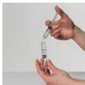
6) Befüllen der Messküvette
