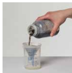
4) Filtration des Extraktes mit einem Rundfilter
