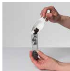
1b) Abmessen des Probevolumens mit dem graduierten Probengefäß (z.B. Gärtnerische Kultursubstrate)
