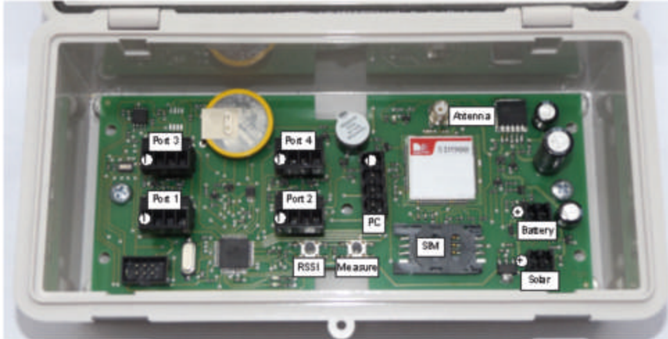
Bild 1: Ansicht der Loggerplatine
